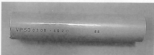
写真3 ボビンに使用する外径60mmのPVCパイプ/VP50
