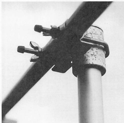
《写真14》マストとの結合。マストも手すりなどにガッチリ固定しよう
