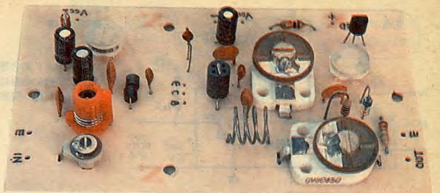
リニアアンプのプリント基板。放熱器がないもの(上)と放熱器が付いているもの(左)
